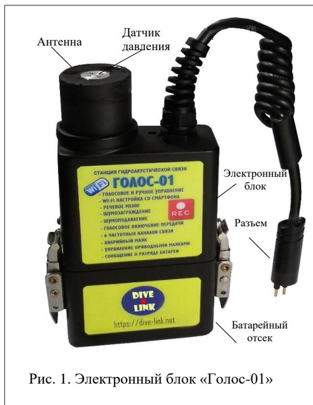
Станция «ГОЛОС-01» (Рис.1) состоит из электронного блока со съёмным батарейным отсеком, и гидроакустической антенной, а также одной из гарнитур связи: для полнолицевой маски AGA (Рис.2)
