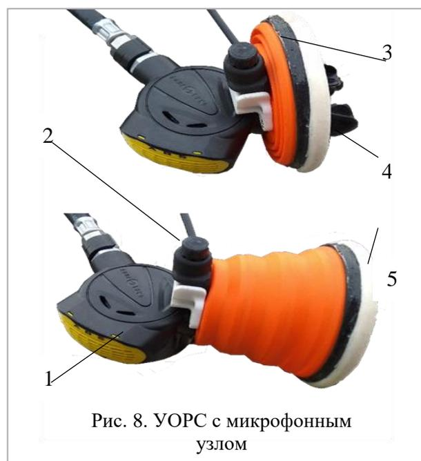
Рис. 8. УОРС с микрофонным узлом
