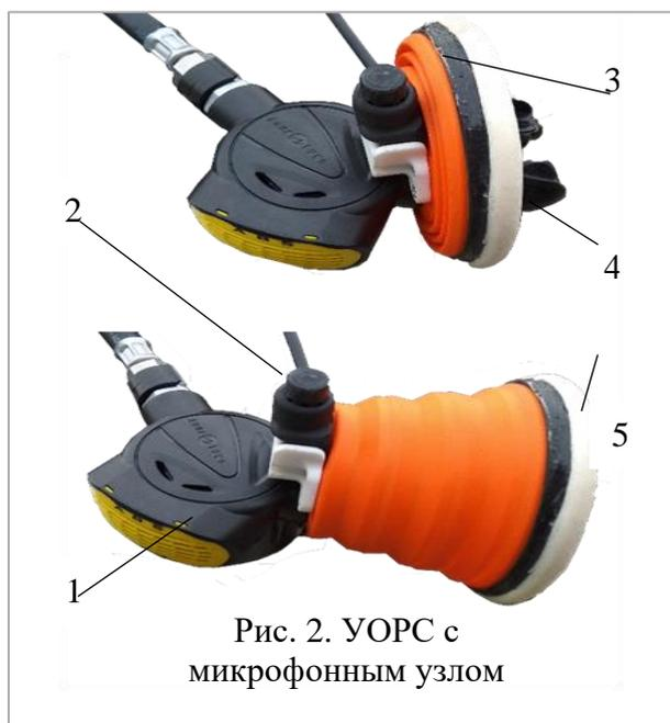
Рис. 2. УОРС с микрофонным узлом
